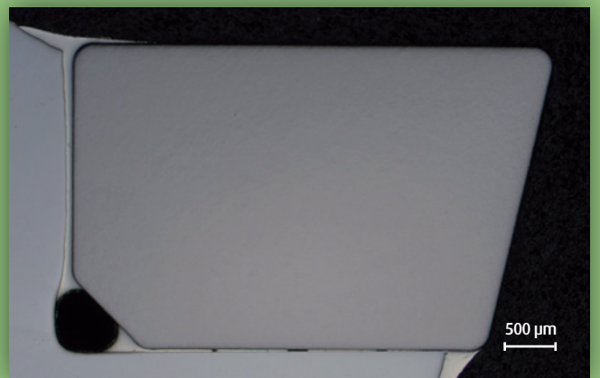
Abbildung 31 | Fehlerhaft ausgeformtes Sägenstammbblatt
