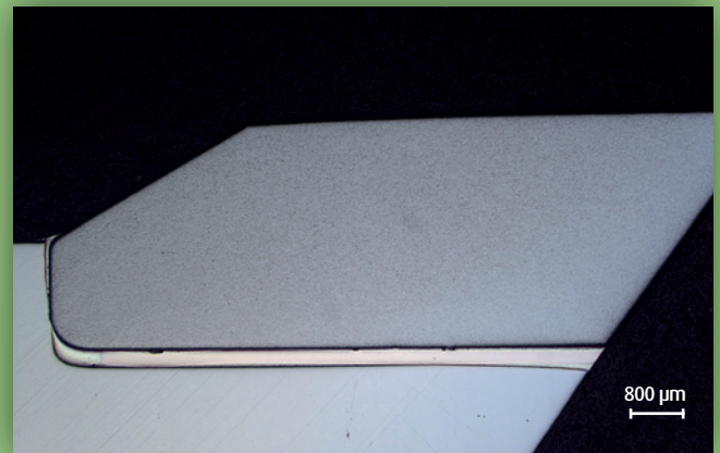
Abbildung 29 | Hartmetall-Sägezahn gelötet mit BrazeTec 49/Cu in direktem Kontakt mit Stahlsitz [38]
