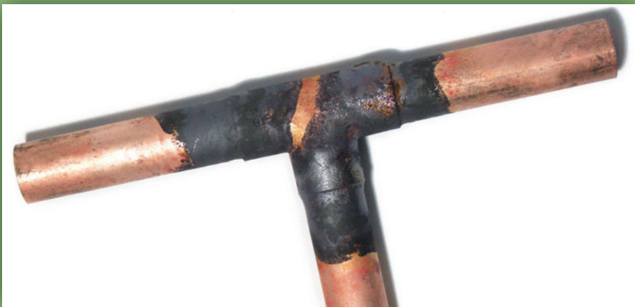
Bild 18 | Typisches Erscheinungsbild einer Silfoslötung
